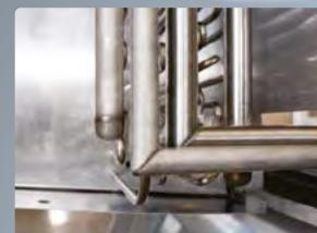
Materiais, projeto e processo de solda conforme norma ASME VIII.
