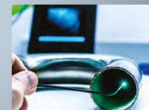
Boroscopia para comprovar a qualidade da solda. Ensaio por líquido penetrante.
