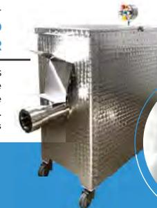
Corpo totalmente em aço inox 304. Possui duas motorizações independentes, uma para o caracol e outra para as pás. Baixo nível de ruídos além de fácil higienização e manutenção. Motor: **5 CV e 1,5 CV para as pás**
