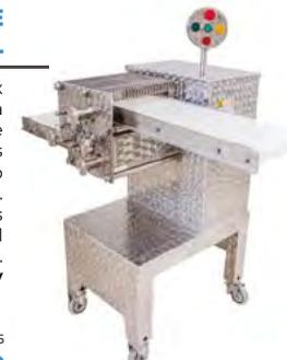
Corpo totalmente em aço 304 com esteira acoplada à máquina e facas que amaciam e cortam as fibras da carne. Amaciamento perfeito sem deixar resíduos. Além do baixo nível de ruídos o amaciador possui fácil higienização e manutenção. Motor - Redutor: **0,75 CV**
