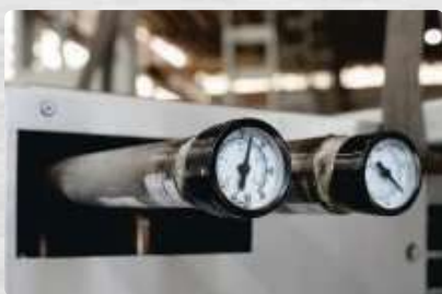
Equipamentos pressurizados com N2 e enviados com manômetros.
