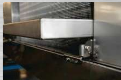
Suporte para apoio de escada para limpeza. Bandeja escamoteável com dobradiças reforçadas em inox.
