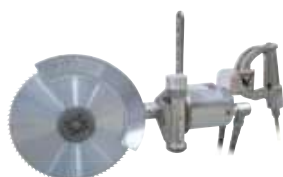
1000FS Serra Circular Hidráulica para corte de PA e separação de dianteiros
